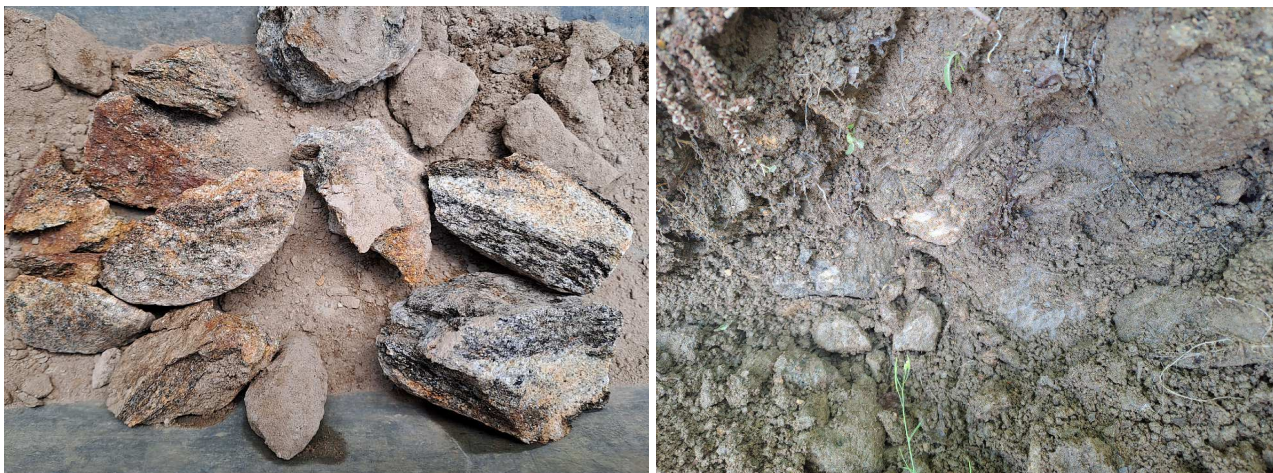
Obr. 4, 5: Hornina ve vrtu VP-3, hloubka 1,8 – 2,0 m (vlevo). Výchoz pararuly v zářezu západě od stávající stavby (vpravo).
