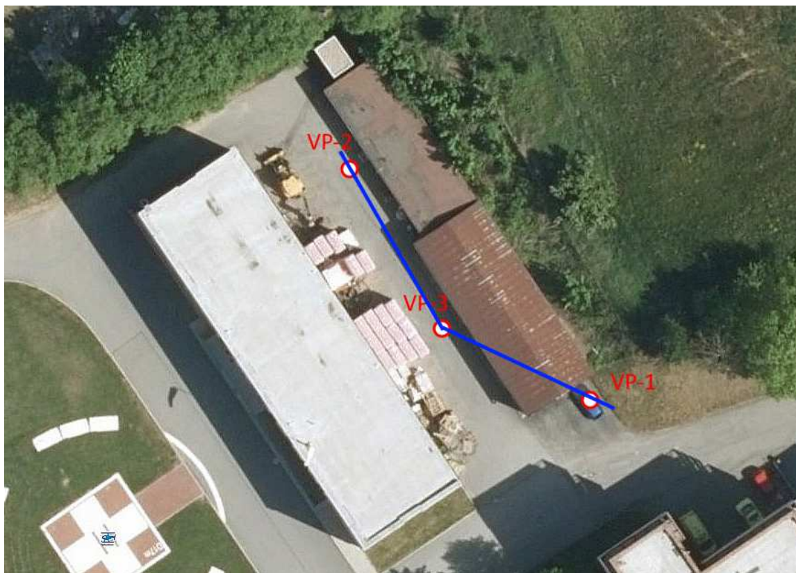
Obr. 3: Situace průzkumných vrtů na letecké mapě s vyznačením průběhu geologického řezu v příloze II.
